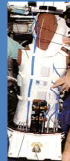
宇宙放射線被曝線量評価実験 (Matroschka)
