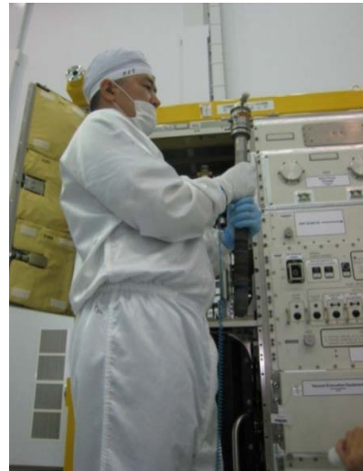
④実験終了(試料冷却)後、試料カートリッジ取り出し
