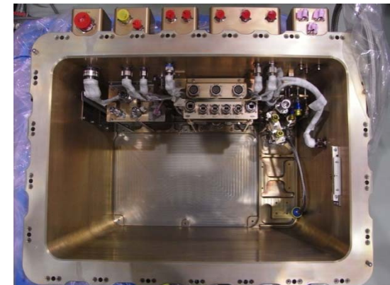
燃焼実験チャンバー内部
