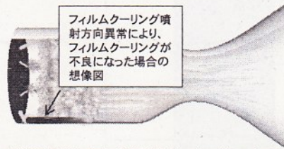
D2) フィルムクーリング噴射方向異常によるスラストノズルの破損
