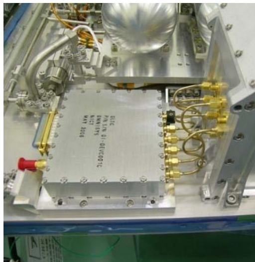
サブミリ波局部発振器 制御部(SLOC)
