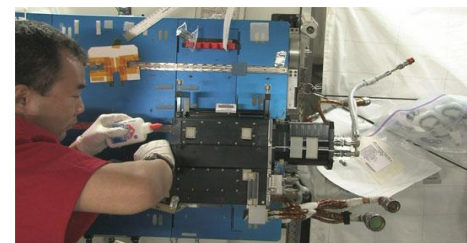
実験供試体の修理作業
