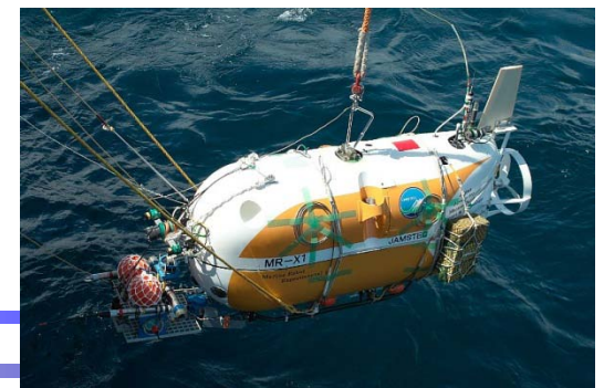
左: 動揺安定台とアンテナ(協力: 東京海洋大)、右: 海洋ロボットMR-X1
