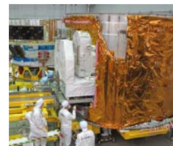
曝露パレット搭載(9/27) 重量・重心測定(10/8)
