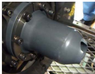
破損進行した 燃焼器
