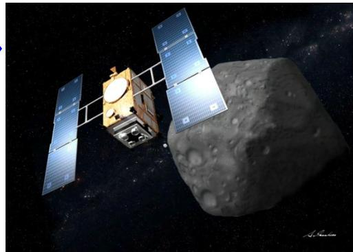
探査機によるリモートセンシング観測では、レーザー測距、多バンド可視カメラ、近赤外分光計、中間赤外カメラなどの機器を用いて、小惑星の特性を調べる。その後小惑星の近接観測、小型ローバ・ランダの投下、表面試料の採取を行う。
