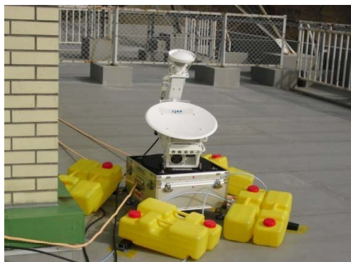
現地対策本部(釜石)に設置された可搬型 USATの外観写真(アンテナ径45cm)
