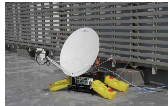
現地対策本部(大船渡)に設置された 可搬型VSATの外観写真(アンテナ径1.0m)
