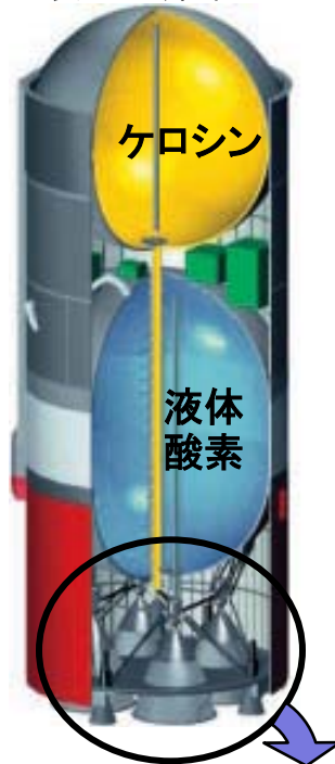
③第3段構成 (3段目全長6.7m、直径2.66m)
