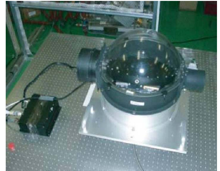
CMG基本制御特性評価実験
