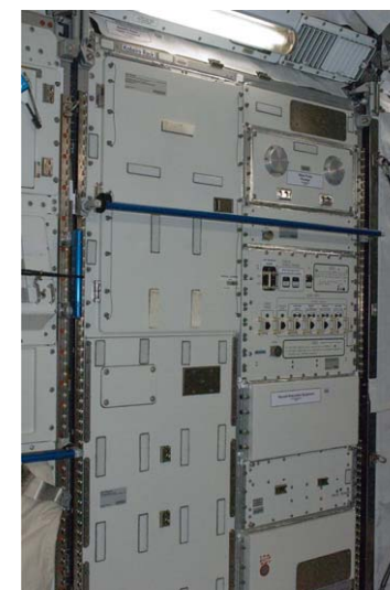
「きぼう」船内実験室に設置された勾配炉ラック
