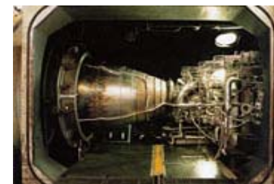
(※)高空燃焼試験 地上にて、真空状態を模擬して行う燃焼試験 (写真はLE-5Bエンジン)
