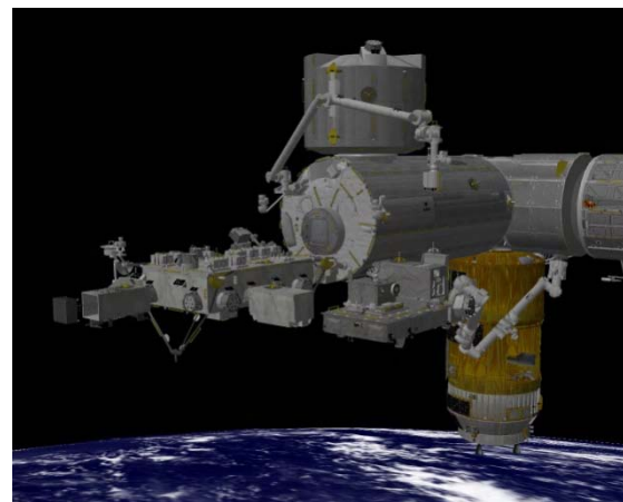
曝露パレットを船外実験プラットフォームに移送する
