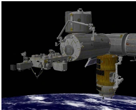
HTVから曝露パレットをISSロボットアームにより取り外す
