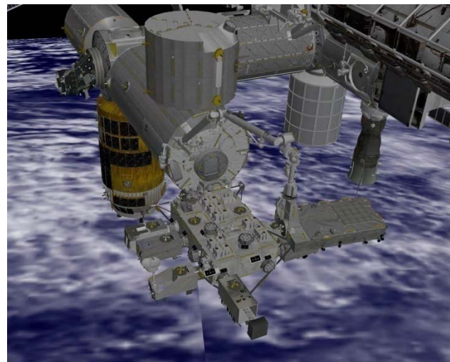
HTV曝露パレットを「きぼう」ロボットアームにより取り外し、HTVに戻す
