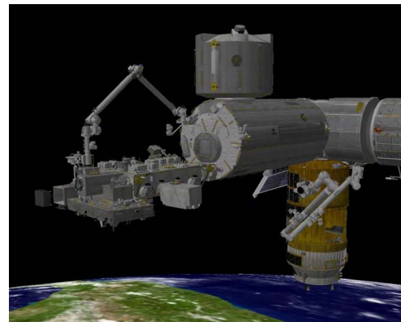
「きぼう」ロボットアームにより船外実験プラットフォームに取り付ける
