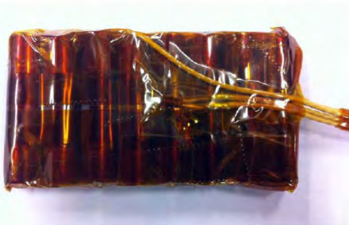
RAIKOのニッケル水素バッテリー(セル容量750mAh x8本)
