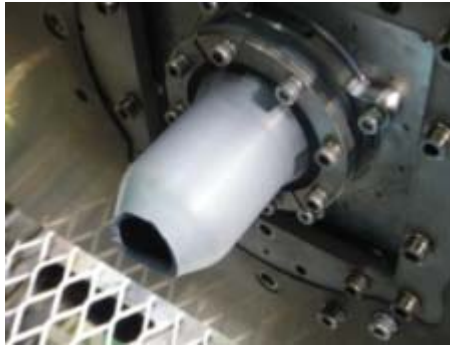
地上燃焼試験後の燃焼器 (スラストノズル部で破損している)
