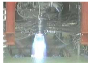
大気圧燃焼試験 (IHI相生)
