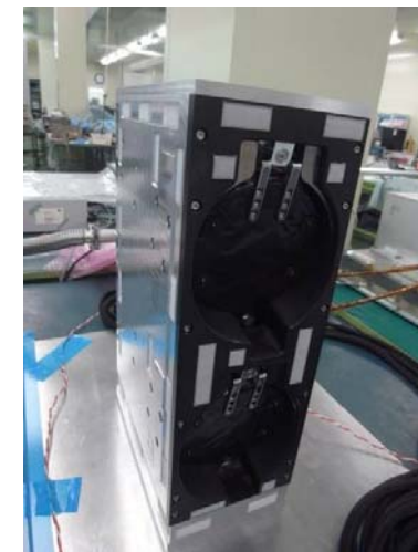
IMAP観測機器 (極端紫外光カメラ)
