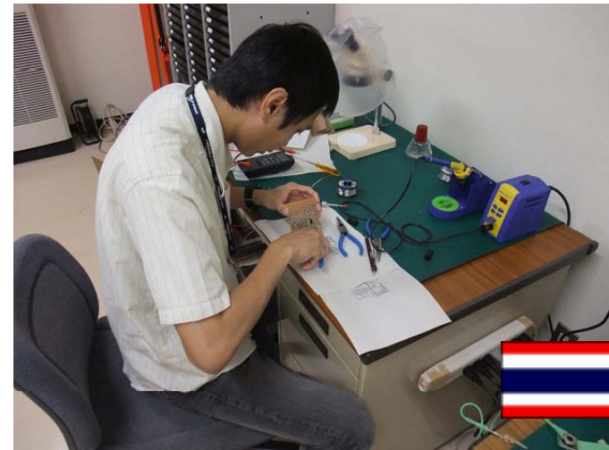
タイGISTDA参加者による 最大電力追尾回路試作
