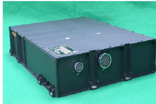
高電圧電源寿命評価モデル
