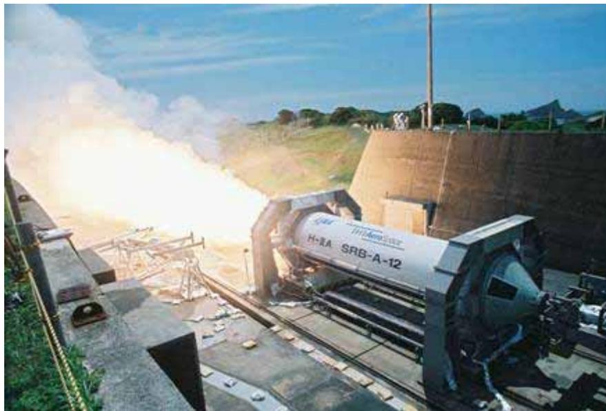
図1 実機大モータデータ取得試験状況
