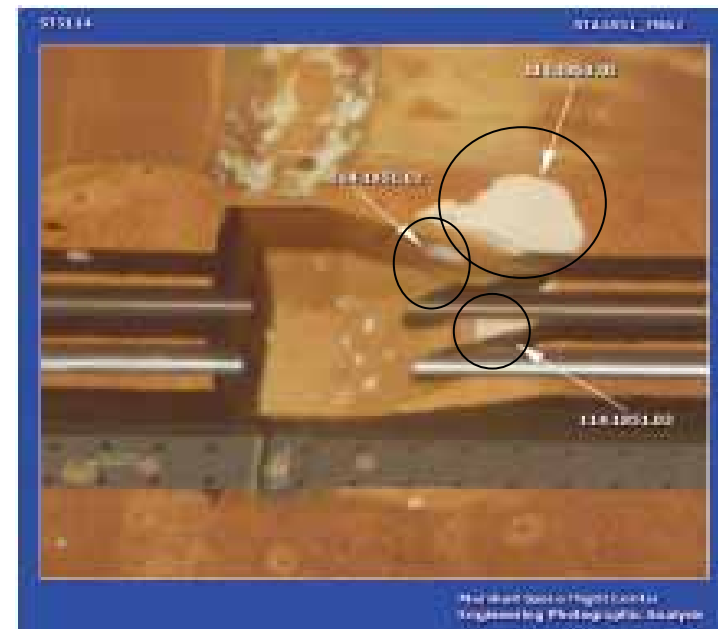
STS-114飛行時の剥離
