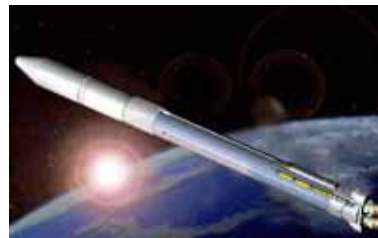
GXロケットに搭載 されたLNG推進系
