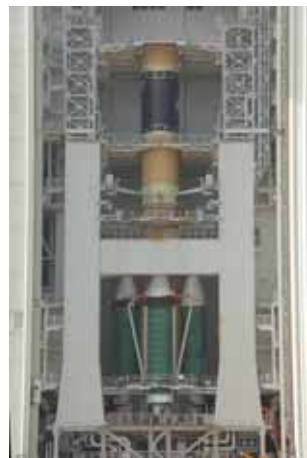
SRB-A(4本)結合作業完了 (H18.10.9)
