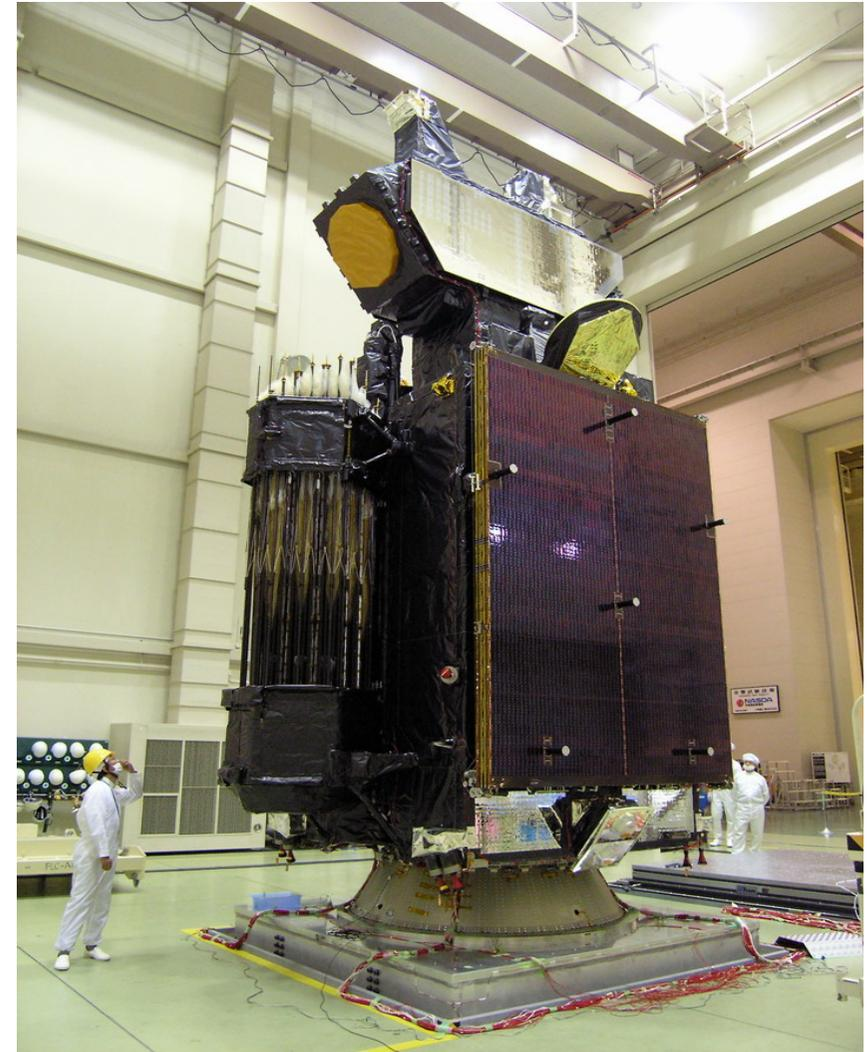
図 I - 3 - 2 システムプロトフライト試験の実施状況 (5/7)
