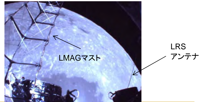
月磁場観測装置(LMAG)マスト及び月レーダサウンダー(LRS)アンテナの進展後の様子
