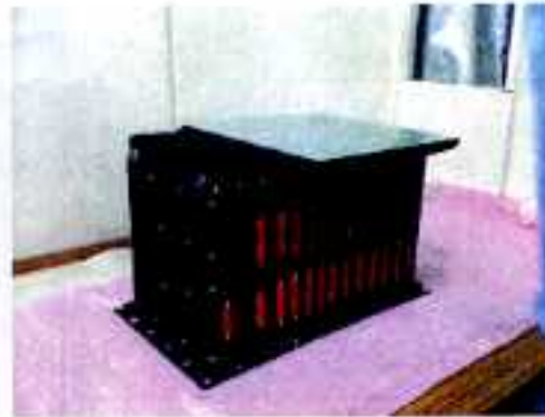
データ処理装置(DP) (実験機器からのデータをきぼうに送信する)
