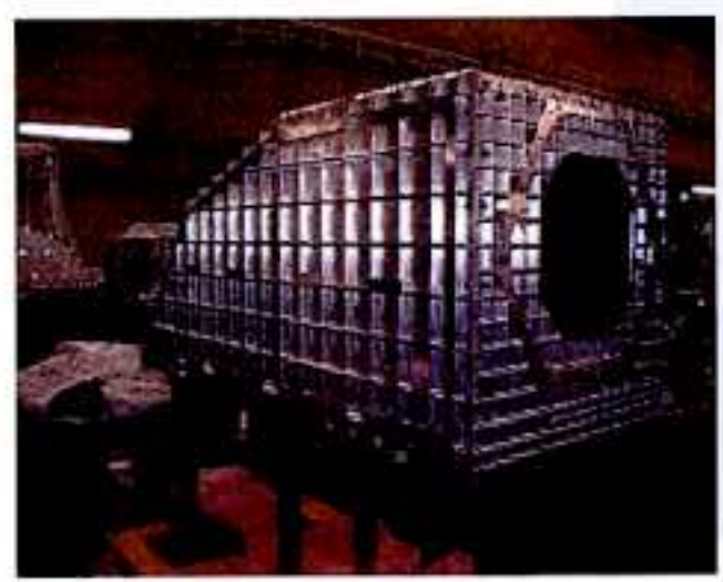
主構造 (アルミフレーム構造)
