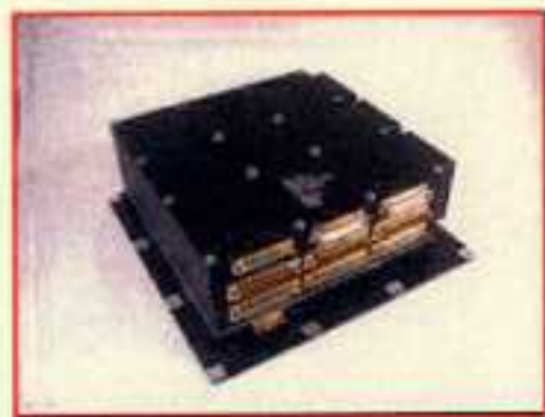
通信制御部 (APRT) (実験機器からのデータをきぼうに送信する)
