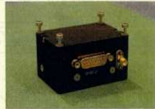
GPSR受信機 (MAXIの位置、速度、時刻を計算する)
