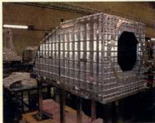
主構造 (アルミフレーム構造)
