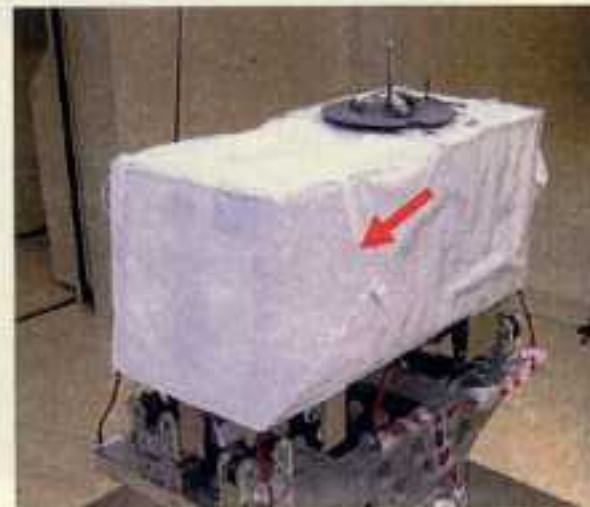
コンタミネーションカバー (打上げ時のカーゴベイ内コンタミを防止する)
