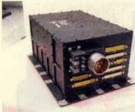
電力分配器(PDAP) (MAXI内の機器に電力を供給する)
