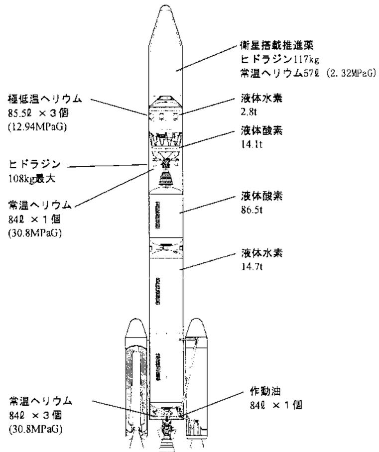
図-1 H-IIAロケット搭載保安物概要(高圧ガス、危険物等)
