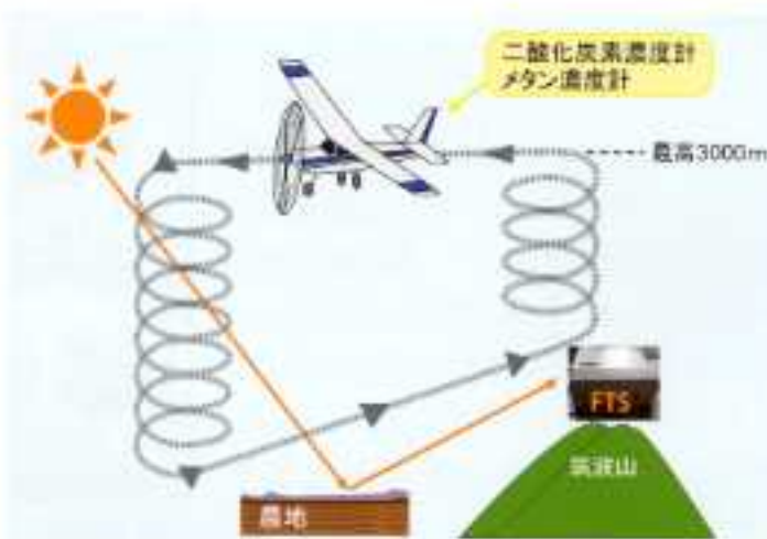
図9. 2005年に実施した筑波山における模擬実験の概要
