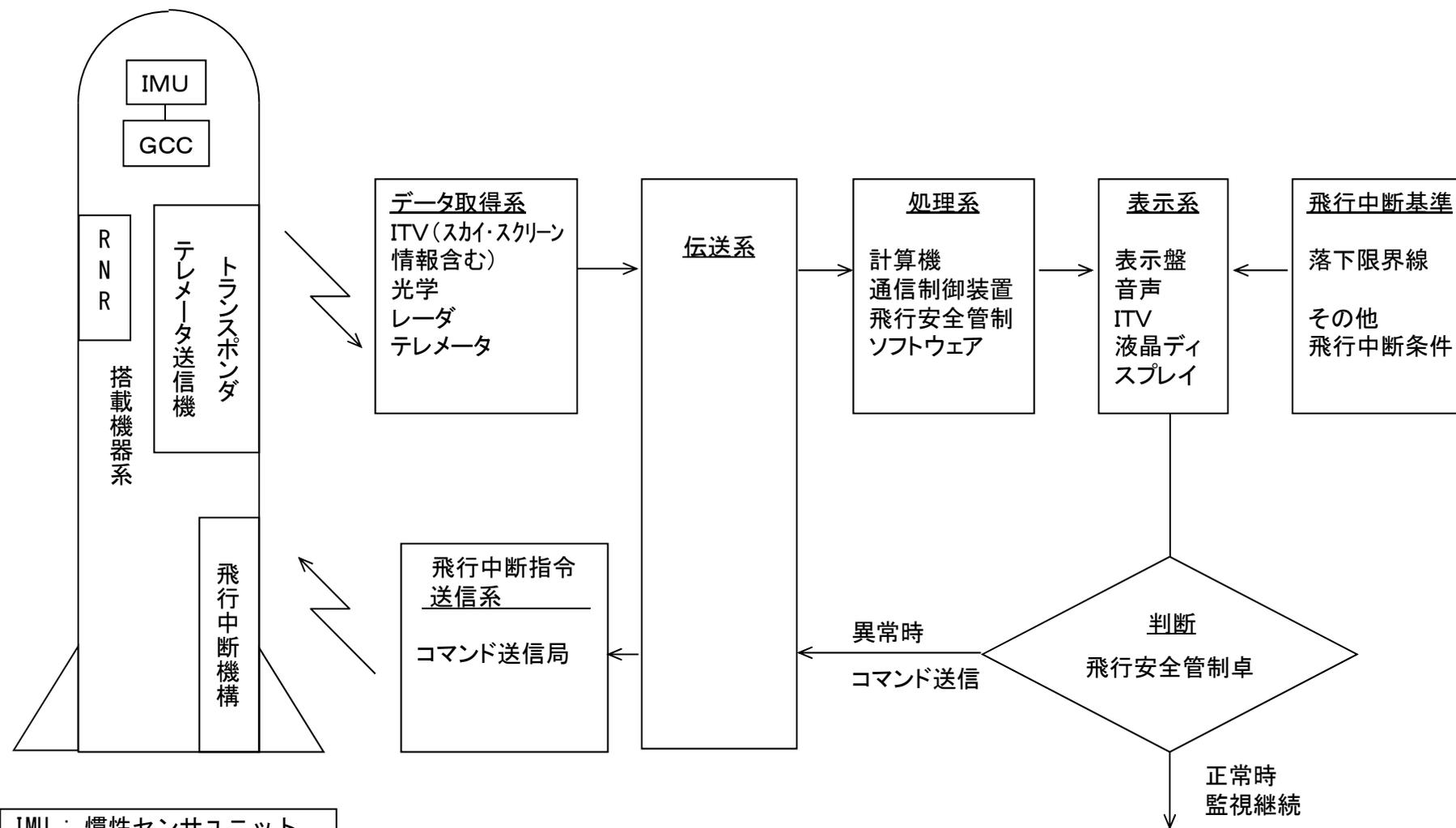
図6 飛行安全システム概念図
