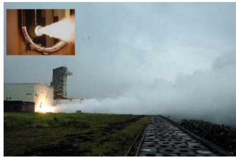
上段サブサイズモータ地上燃焼試験 (2011年9月能代ロケット実験場にて実施)
