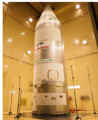
衛星フェアリング音響試験 (2013年2月筑波宇宙センターにて実施)
