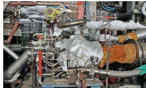
CE20(Cryogenic Engine) 統合ターボポンプ試験
