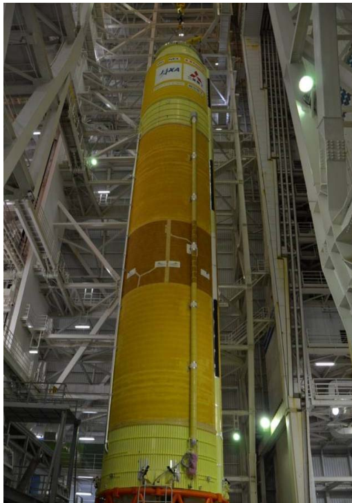
第1段起立 (H24.3.17完了)
