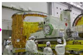
曝露パレット搭載(3/14) 重量・重心測定(3/28)
