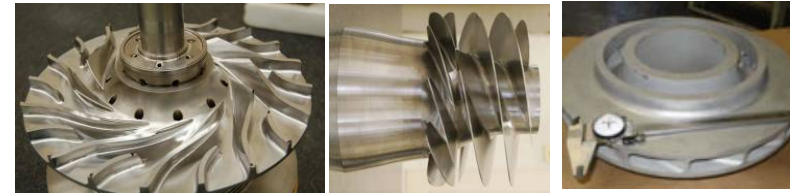
オープンインペラ、2段インデューサの採用 粉末冶金による一体成形
