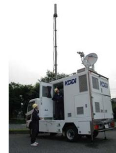
災害時の非常用エントランス回線として衛星ネットワークを利用した携帯電話基地局を特設
