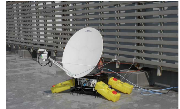
現地対策本部（大船渡）に設置された 可搬型VSATの外観写真（アンテナ径1.0m）
