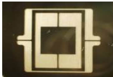
次期探査機の高度計への利用が期待されるスキャンミラー
