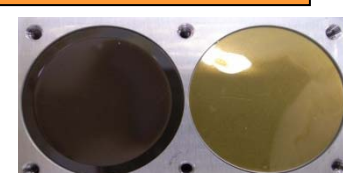
紫外線や原子状酸素等による宇宙用材料の劣化評価
